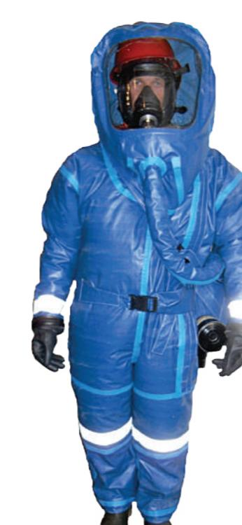
Предназначено для защиты в условиях второй и третьей зон заражения. Используется с фильтрующими средствами защиты органов дыхания. Реализован принцип раздельного расположения лицевой части и источника очищенного воздуха. Имеет узел очистки и подачи воздуха для дыхания и вентиляции подкостюмного пространства
